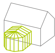
A padiglione con raccordi a 135°
