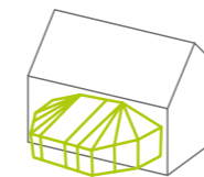
A più falde raccordate a 135°
